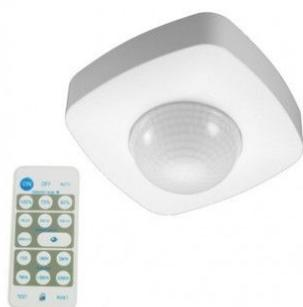
Ce détecteur de mouvement est destiné au plafonds de grande hauteur, en intérieur. Équipé de 3 cellules infrarouge sa portée peut atteindre 20 mètres. Il réagit aux émissions thermiques (infrarouges) issues des personnes (ou animaux) en mouvement dans la zone de détection du capteur. Quand le capteur détecte un passage dans sa zone, la lampe que vous lui avez raccordée s'allume. Elle s'éteint automatiquement après la fin de la détection de présence (durée réglable).
