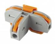
Connecteur rapide en T pour joindre rapidement un câble électrique à 2 conducteurs. dimensions :  $40 \text{mm} \times 40 \text{mm} \times 18 \text{mm}$  - Tension : 230 V max - Courant : 32 A max.
