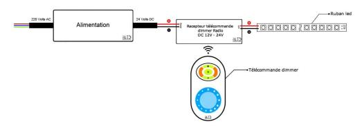
Découvrez d'autres schémas & aides au branchement des rubans LED en cliquant ici.
