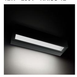
**Applique LED murale rectangulaire 12W.** Intérieur ou extérieur - IP54 - Angle de diffusion :  $120^{\circ}$  - 230 volts direct par bornier étanche - Dimensions : 7,2 cm x 22 cm x 3,2 cm.
